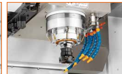
主軸獨立環噴裝置(選配) 主軸鼻端裝有8個沖屑噴嘴，提供 強力、大流量的沖屑效果。 (e-750A/850/1000/1100/1300 /1100y+/1300y+)
