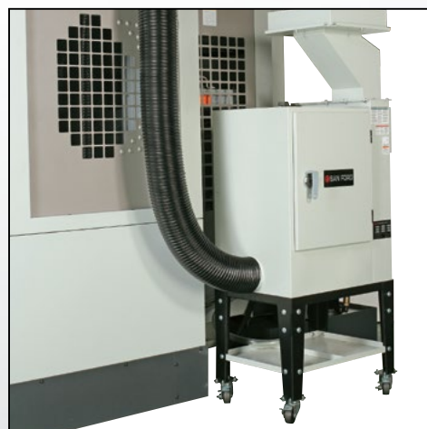
> 油霧回收裝置
